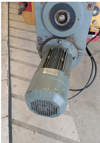
Figure 2: Esquerda: conjunto motoredutor (SEW) instalado em campo — a máquina rotativa cuja vibração é monitorada. Direita: bancada de ensaio instrumentada (motor + redutor + acoplamento) usada para validar o conceito de medição.
