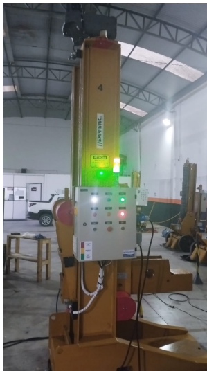
Figure 1: Em campo: coluna de elevação industrial (EMPRETEC) energizada com torre de sinalização em operação, e o painel de comando (inversor WEG CFW300, disjuntores-motor, contadores e relés) que aciona o conjunto. É sobre máquinas rotativas assim que o sensor de vibração atua.
